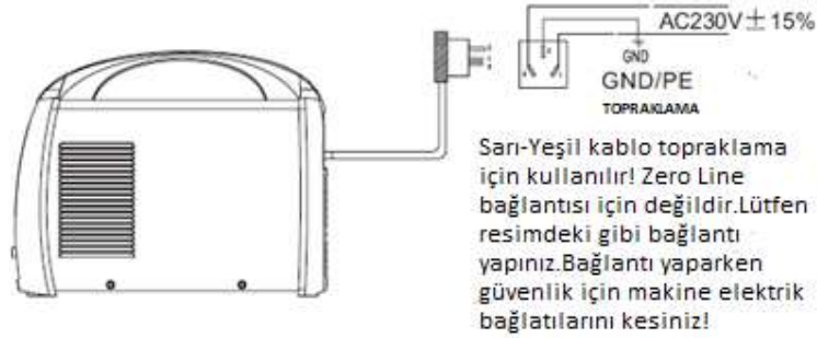
Giriş güç kaynağı kablosu sviç kutusu arasındaki bağlantı
